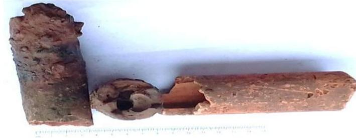
**Photo 22:** Fragments de tuyères scarifiées (à gauche) et bouchées (au centre)
